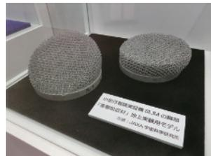
図3:SLIMの足に取り付けられる衝撃吸収材（地上試験で使用したもの）
