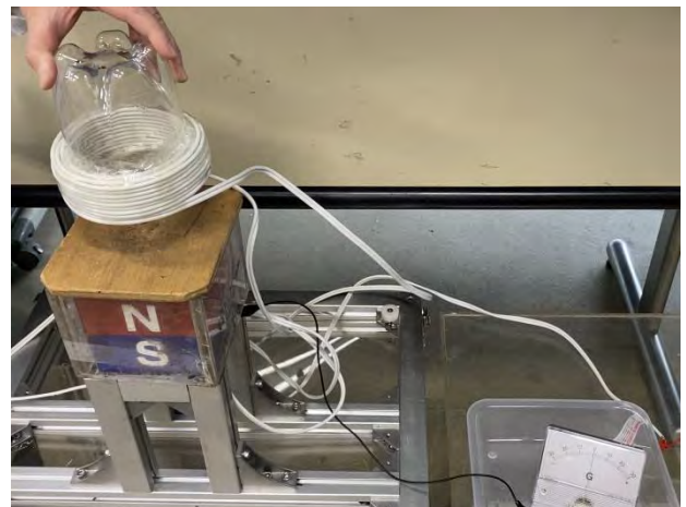
写真2. 電線を動かすと検流計の針が振れる。
