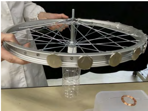
写真3. 磁石を貼り付けた車輪を回転させる。
