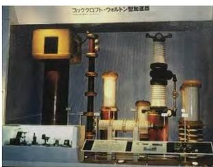
図 33 コッククロフト・ウォルトン型加速器
