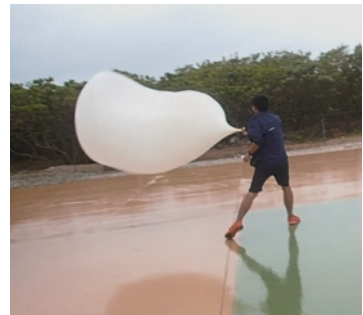
南鳥島での放球 風速17m/sの強い風が吹き、 気球が変形しています。
