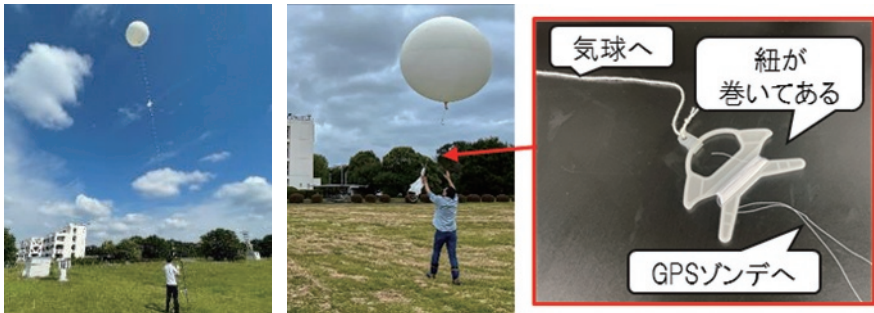
放球の様子(左図:巻下器不使用、中図:巻下器使用)と巻下器(右図)
