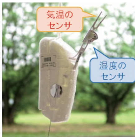
風船に取り付ける観測器(GPSゾンデ)
