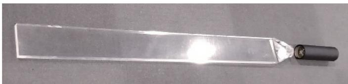
ような形をした光電子増倍管(光を電気信号に変換する真空管の一種)を取り付けて使います。宇宙線はプラスチックを通過するとシンチレーションといって弱い光を出します。シンチレーションが起こる物体がシンチレータ(今の場合プラスチック)です。光はシンチレータ内部で何度か反射して円筒状の部分に集まってきます。その光を光電子増倍管で電気信号に変えるというわけです。
