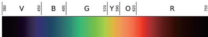
図1. 可視光のスペクトル。上の数字は波長/nm。 アルファベットは、おおよそ対応する色の頭文字 (Violet, Blue, Green, Yellow, Orange, Red)
