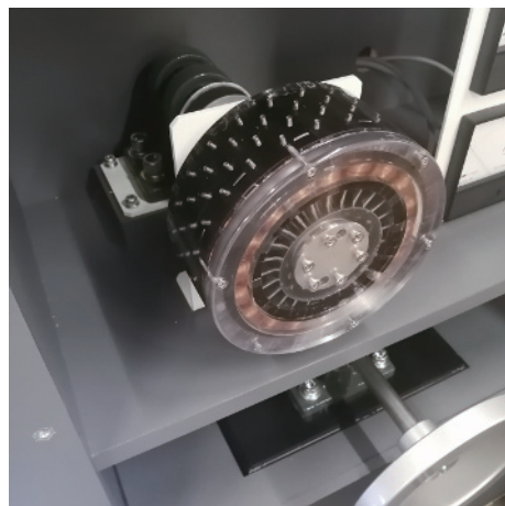
写真2. 心臓部の風力発電用コアレス発電機。コイルに鉄芯がない、特別な磁石の配列など様々な工夫で、小さな回転力で大きな電力をおこします。
