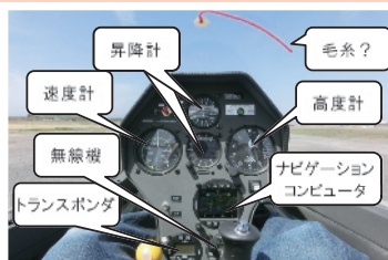
写真14 DG-1000の計器盤
