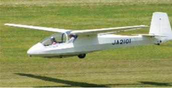
写真4 鋼管羽布張り機
