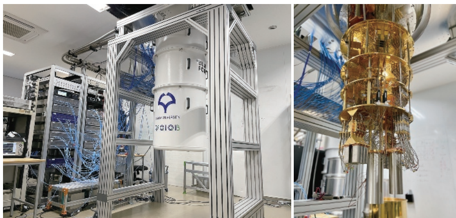
図2. (左)大阪大学の超電導型量子コンピュータ実機。 (右)大阪大学の超電導型量子コンピュータ実機の外側のカバーを外したもの。
