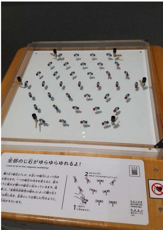
相邻的两个磁铁会因为相互的磁力而改变方向。如果改变其中一个磁铁的方向，摇摆的动作就会像波浪一样传递到相邻的磁铁。当它静下来时，由于“自发对称性破缺”，相邻的磁铁会朝向某个方向，所有磁铁都会集体对齐方向，组成一个闭合的圆。
