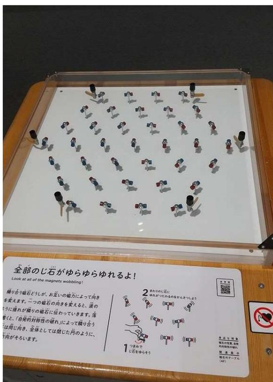
隣り合う磁石どうしが、お互いの磁力によって向きを変えます。一つの磁石の向きを変えると、波のようにゆれが隣りの磁石に伝わっていきます。落ち着くと、「自発的対称性の破れ」によって隣り合う磁石は特定の向き、全体としては閉じた円になるように、磁石が群で方向をそろえます。
