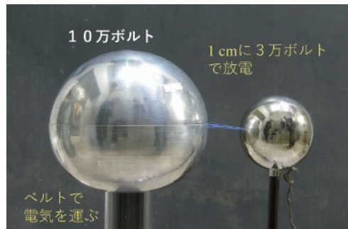
図4. 小型バンデグラフでの高電圧の発生実験
