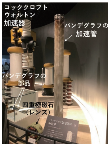
図1. バンデグラフの加速管、後の装置はコッククロフト ウォルトン加速器
