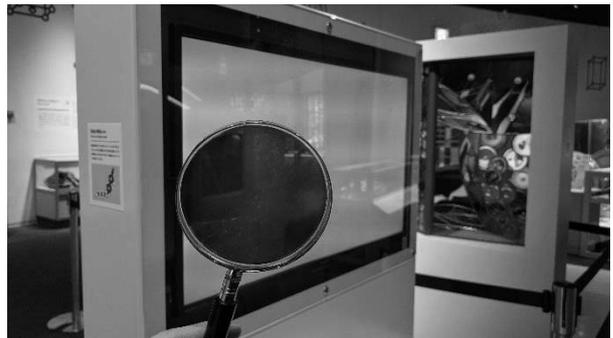
新展示。白一色に表示された液晶モニタを偏光板越しに観察すると、フルカラーの映像が見えるようになる。液晶テレビは液晶層を挟む偏光板のうち観察者側の1枚を取り除いている。「液晶」自体を「観察」しているわけではないが、来館者にとっては衝撃的な体験を与える。
