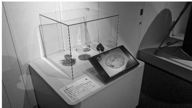
新展示。カッター替刃や鉄釘のサビの進行をケース内で実験しながら、様子を撮影し、タイムラプス編集しモニタに表示している。一般的にも身近な現象であるが、日常的には変化を目で追うほど速くないため、紹介する化学反応としてふさわしいと考えた。
