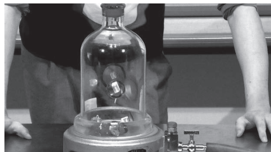
図3. 真空鐘内の吸盤が落下する
