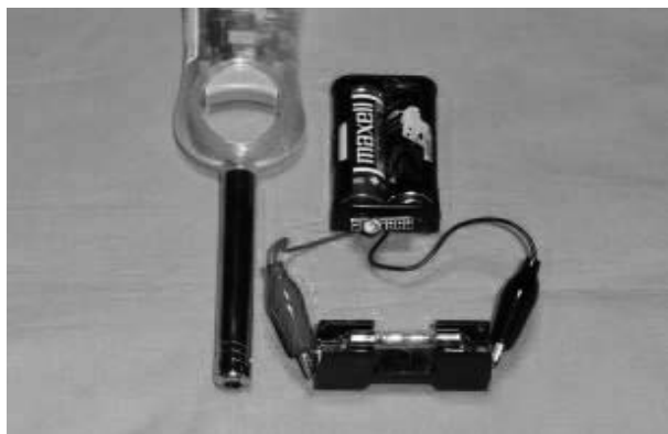
写真26. 現代のコヒーラを用いた実験
