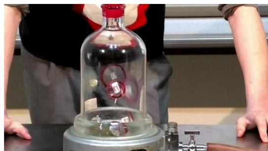
図3. 真空鐘内の吸盤が落下する
