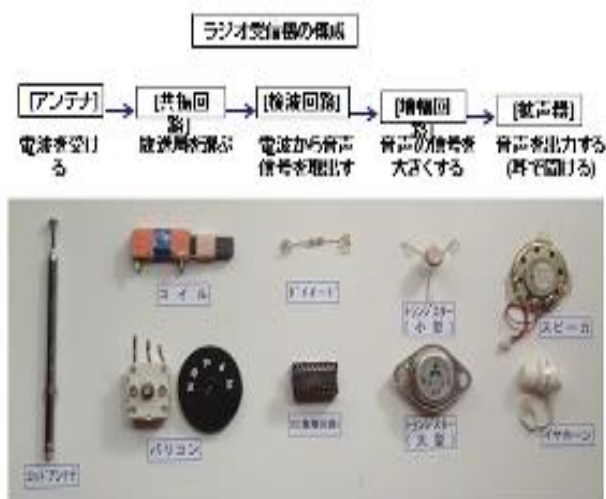
写真2. ラジオ受信機の構成パネル
