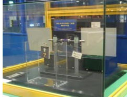
写真36. ヘルツが電波を実証した装置例
