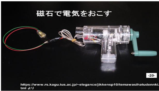
写真32. 磁石が動くと傍にあるコイルに電流が生じる
