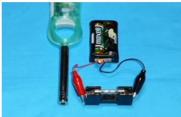
写真26. 現代のコヒーラを用いた実験
