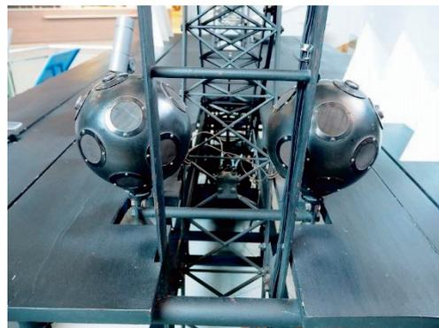
写真 15: 子午線投影機。写真右側が北に当たる。
