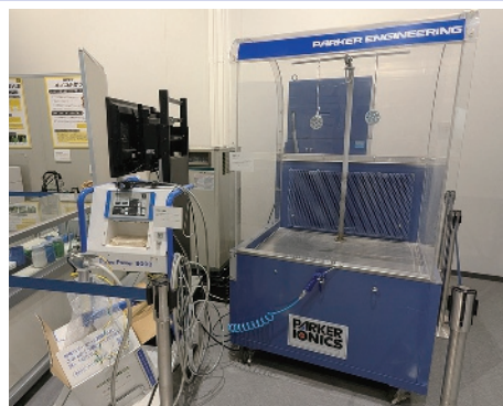
図4. 静電粉体塗装の塗装ブース。 (協力: パーカーエンジニアリング株式会社)
