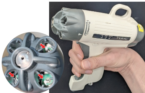
図9. イオナイザ。用途によって卓上用や空間用などさまざまな形状があるが、これはガンタイプ。銃口に細い針が見える。(協力:株式会社TRINC)
