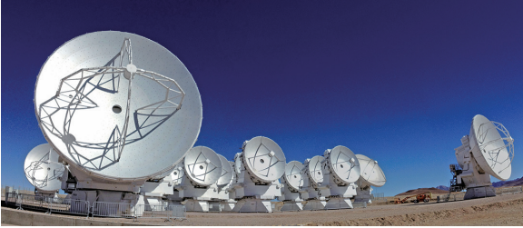
図1. アルマ望遠鏡の一部であるアタカマ・コンパクト・アレイ。愛称は「モリタアレイ」。口径7メートルのアンテナを近くに並べることで、空に広がった分子雲コアの姿を捉えやすい。Credit: ALMA (ESO/NAOJ/NRAO)
