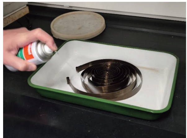
写真9. 金属板に洗浄剤をかけている様子
