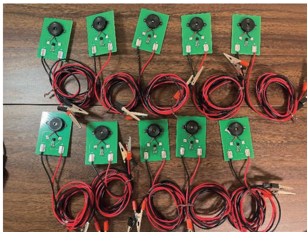
写真 21 科学デモンストレーターが基板の設計から組み立てまでした電子オルゴール
